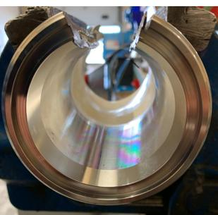
Exemple d'une découpe d'un flexible ALIKLER G2 assemblé et sertie dans notre atelier Artère : **Absence de zone de rétention visible.**
